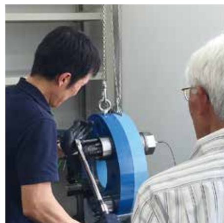
手工具のみでM30以上の太径ボルトを締結できるスーパーボルトの締結方法を実演中。写真はM56の締結。
