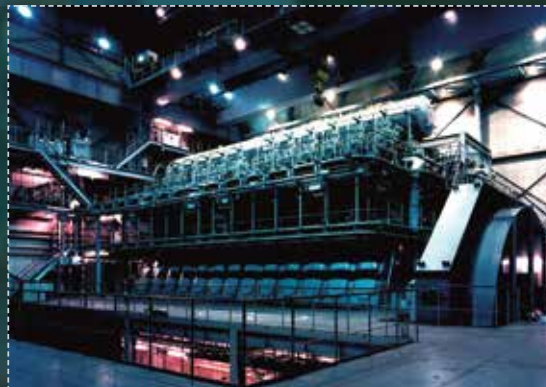
千葉県に試験設置された、世界最初のガス燃料式ディーゼルエンジン。発電用途であったが、ここから得られた知見が、独自技術の一つであるガス2元燃料式エンジンの礎となっている。
