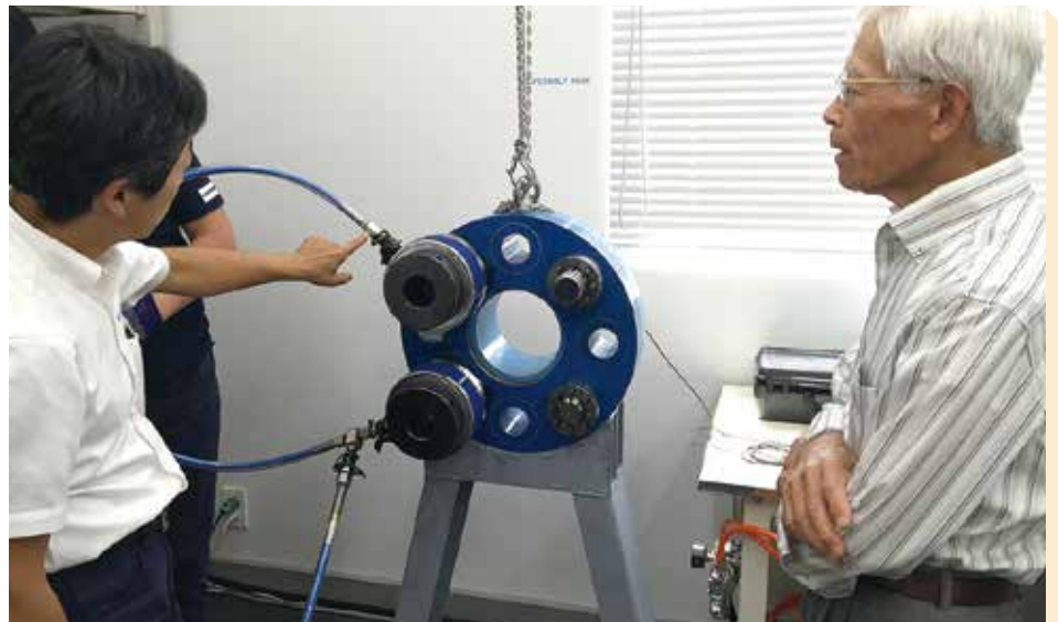
ボルトタイト油圧テンション機の機構をご紹介中の1枚。複数の太径ボルトを均一の圧力で同時に締結できる。
