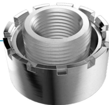
“Poiché il Superbolt HyFit ha un diametro maggiore, possiamo ridurre la lunghezza dell’innesto della filettatura, poiché abbiamo ancora la stessa sezione trasversale di contatto. L’innesto della filettatura è superiore al necessario, quindi possiamo tranquillamente applicare il pieno carico sul dado sapendo che non ci saranno problemi di sicurezza”, spiega Steve Brown.
