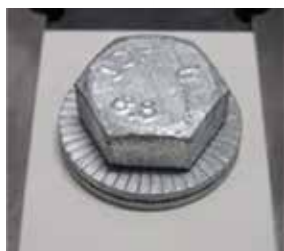
Figur 1. Spændt Nord-Lock skive på malet overflade
