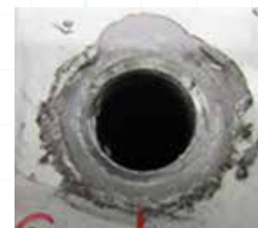
Figur 4. Malet overflade efter Junkers vibrations-test med kun bolthoved. Fjernelse af maling og revner i malingen ses tydeligt.
