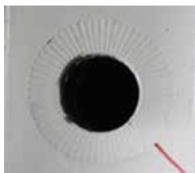
Figur 2. Malet overflade efter Junkers vibrationstest med Nord-Lock skiver. Tydelige tandaftryk i overfladen
