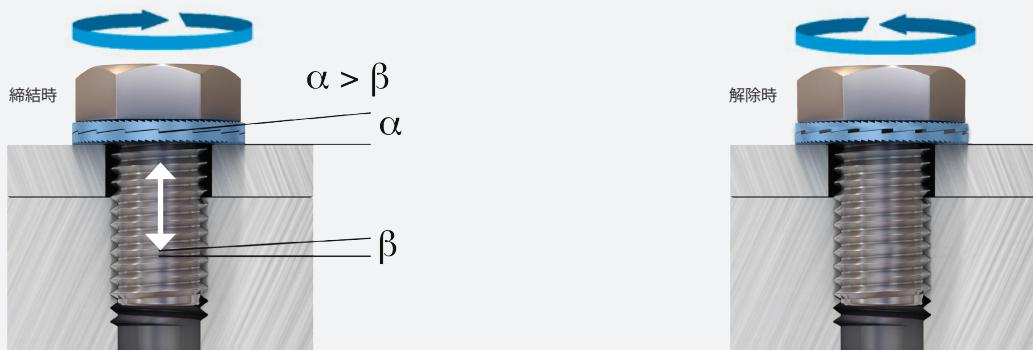
ボルトまたはナットを締め付けるとカム同士が噛み合い、2枚組外側のリブがボルト／ナットと相手材表面にグリップして固定します。このグリップ跡はボルト／ナットと相手材双方にインプレッションマークとして残り、緩み止め効果が作用している証となります。
