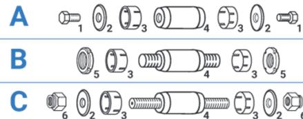
1. Schraube 2. Spannscheibe 3. Expander-Hülse 4. Achse/Bolzen 5. Nutmutter 6. Mutter
