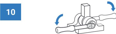
Um das Expander System zu demontieren, lösen Sie die Befestigungselemente an beiden Seiten und entfernen Sie die Scheiben.
