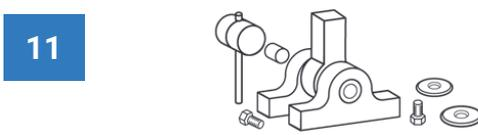
Klopfen Sie nacheinander auf die linke und rechte Seite auf der Achse, bis die Spannung an den Hülsen gelöst ist. Entfernen Sie die Hülsen und die Achse. **Beschädigen Sie nicht die Gewinde.**
